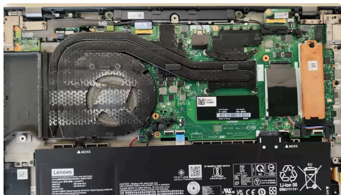
Antes Ventilador saturado de polvo: menos ventilación y más temperatura.
